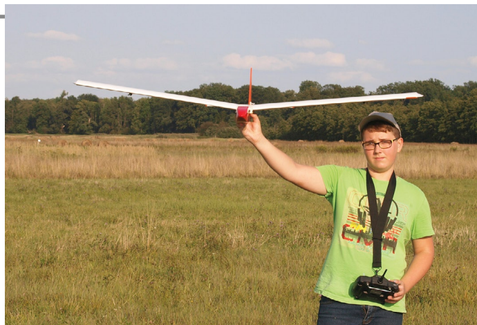
...i po modyfikacji wzniosu powiększonego do około 10°
