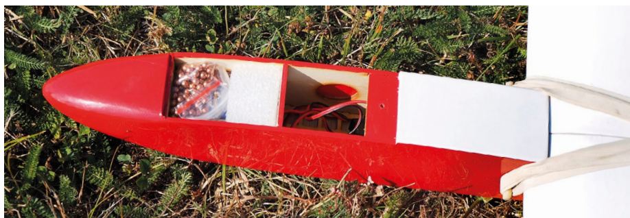
Konieczność dużego dociążenia dzioba to między innymi efekt użycia do budowy modelu ciężkiej balsy, bo ta lekka jest aktualnie w handlu trudno dostępna
